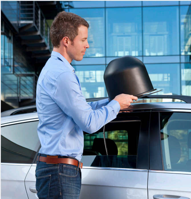
Настройка мобильного радиопеленгатора выполняется за считанные минуты (антенна R&S®ADD107 и автомобильный адаптер R&S®ADD17XZ3 с магнитным креплением)
